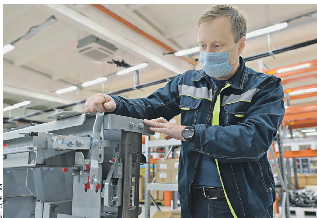
30 октября 13:45 Главный конструктор производственной компании «Мослифт» Игорь Иванов рассказывает, как работает одна из систем безопасности подъемника — уловитель
